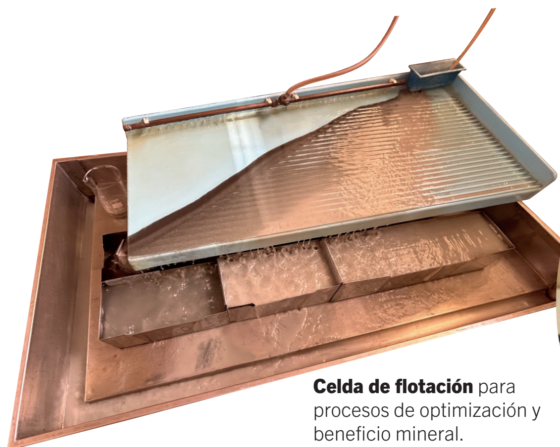
Mesa de sacudidas (mesa Wilfley) para separar y concentrar minerales que permiten datar las rocas.
