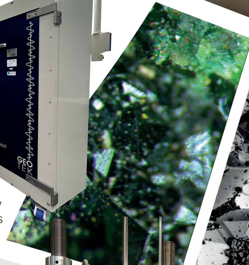
Tomógrafo para obtención de imágenes en 2D y 3D para analizar estructuras internas de testigos de sondeo.
