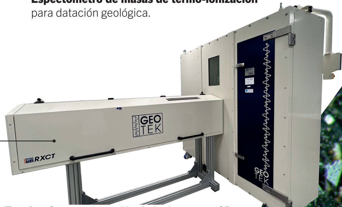
Tomógrafo para obtención de imágenes en 2D y 3D para analizar estructuras internas de testigos de sondeo.
