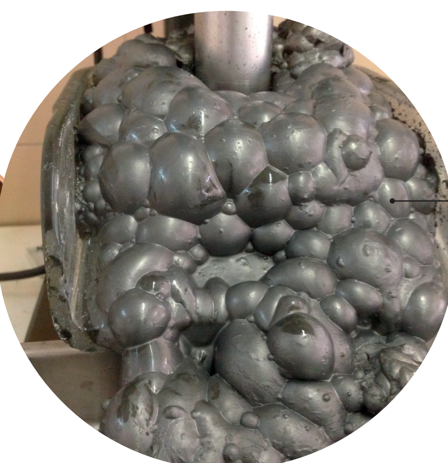
Celda de flotación para procesos de optimización y beneficio mineral.
